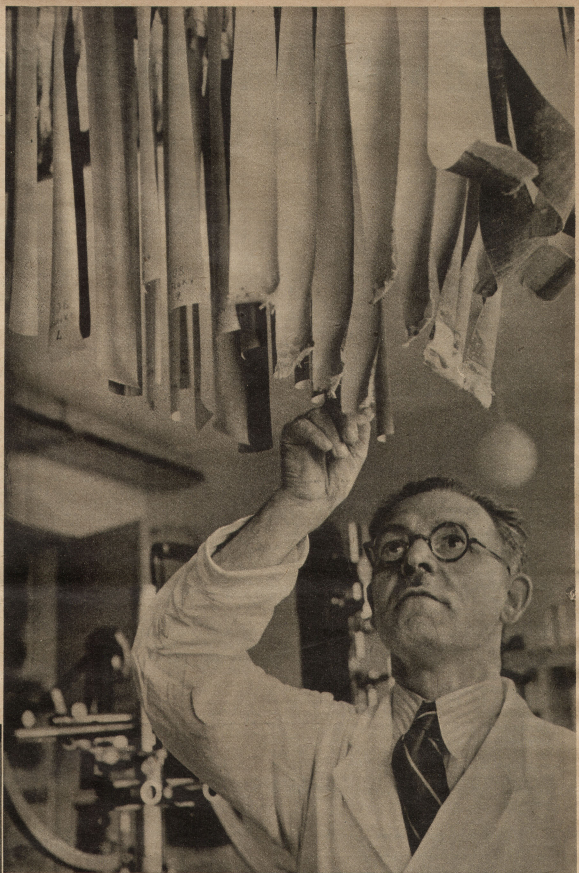
Las telas de revestimiento de los aviones son también sometidas a examen. Las tiras de tela tratadas según diferentes procedimientos son colocadas en la máquina para comprobar la resistencia de tensión (foto a la derecha). Durante la prueba se observa cuando salta el barniz del que están provistas las tiras de tela. El tambor a la derecha en la foto registra el diagrama de tensión
